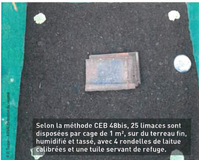
Selon la méthode CEB 48bis, 25 limaces sont disposées par cage de 1 m<sup>2</sup>, sur du terreau fin, humidifié et tassé, avec 4 rondelles de laitue calibrées et une tuile servant de refuge.
