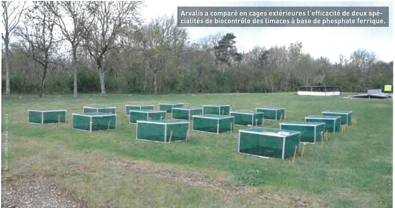
Arvalis a comparé en cages extérieures l'efficacité de deux spécialités de biocontrôle des limaces à base de phosphate ferrique.
